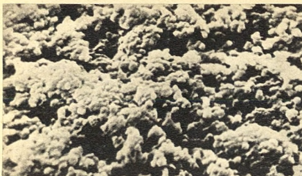
Bild 3. Aufnahme mit Hilfe eines Elektronenmikroskops der chemisch aufgerauhten Oberfläche des Haftvermittlers. Vergrößerung: etwa 13 000-fach (Aufnahme: Schering AG)
