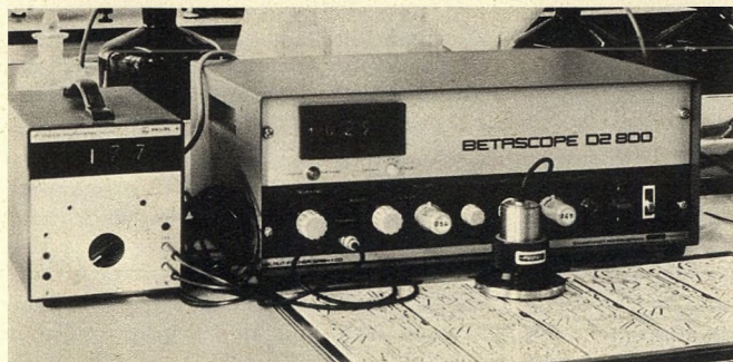
Bild 8. Zur laufenden Messung der Kupferschicht wird ein Betascope verwendet, welches \beta -Strahlen emittiert, und deren Rückstrahlung über eine Geiger-Müller-Zählröhre gemessen wird
